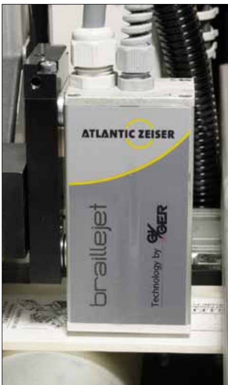
Der BRAILLEJET-Druckkopf gibt zwei Braillezeilen gleichzeitig aus.
