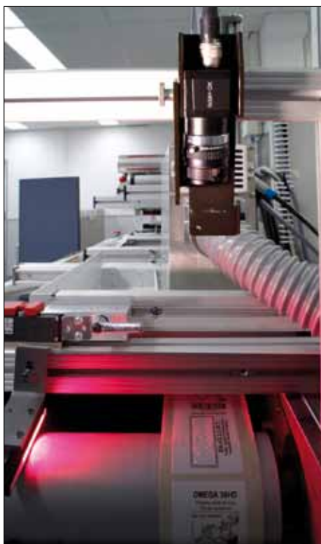
Die Inlinekamera BRAILLE VISION sorgt für die lückenlose Qualitätskontrolle des Produktionsprozesses.
