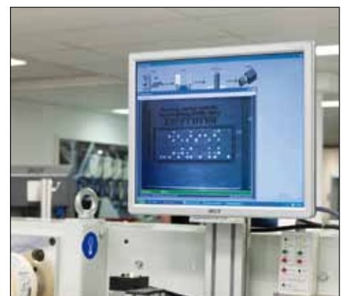
Das BRAILLEJET-System ist ausserdem um Rücklesesysteme zur Produktüberwachung ergänzbar.
